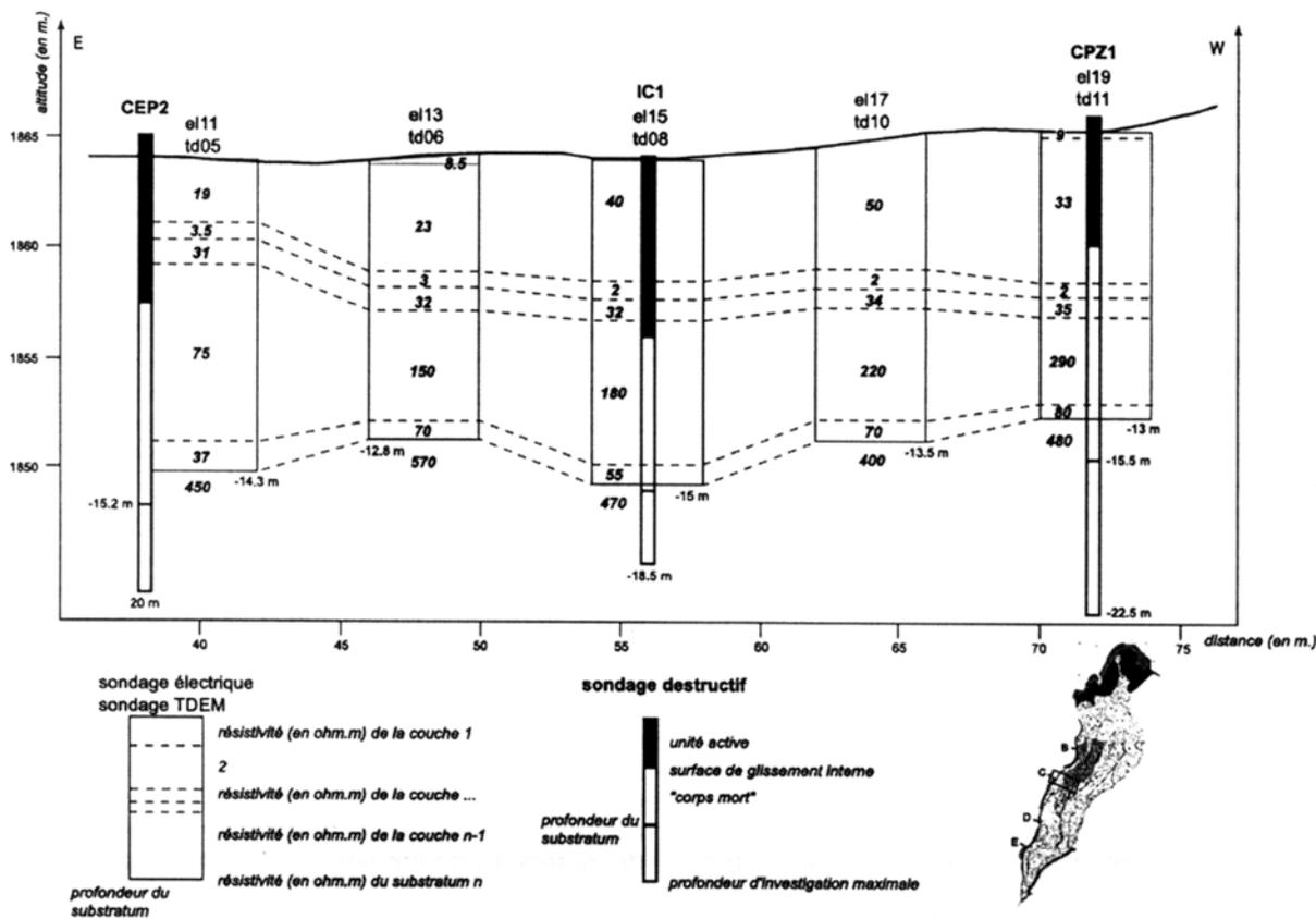
FIG. 5 Interprétation jointe de cinq couples de sondages TDEM-électrique avec sondages géotechniques sur le secteur Est du transect C (localisation sur la figure 2A).
